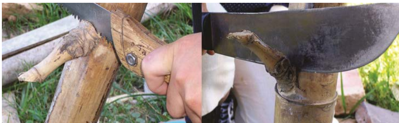
Fotografía 65. Limpieza de ramas laterales
