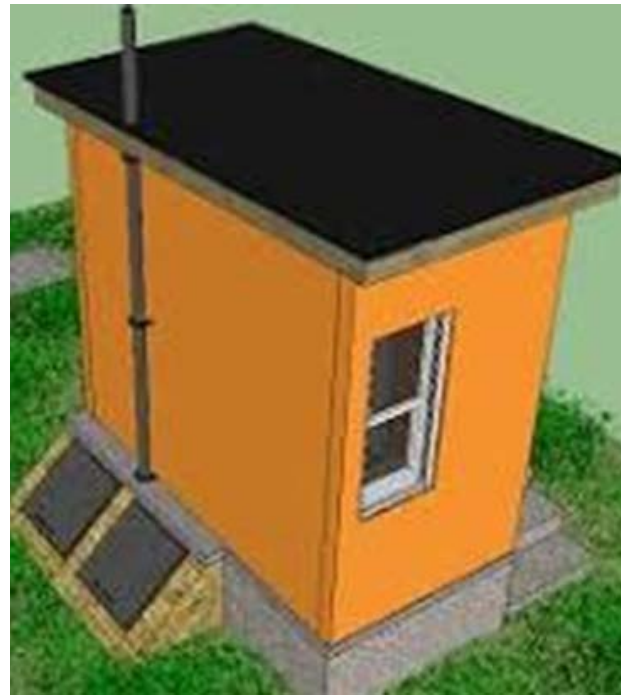
Figura 10. Esquema de baño seco de doble cámara
