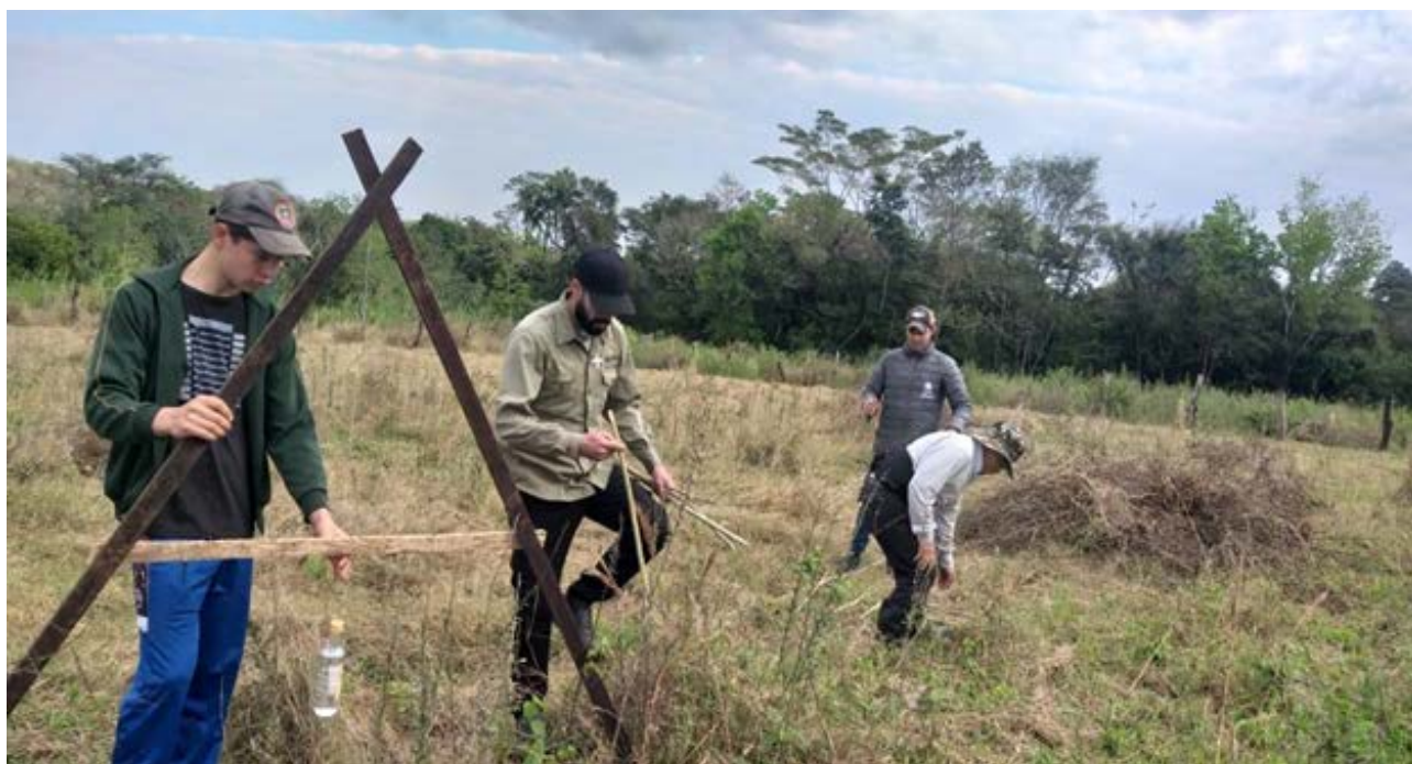
Fotografía 24. Utilización del nivel tipo A
