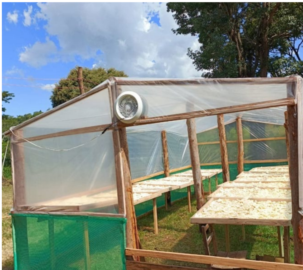
Fotografía 78. Secadero solar para procesamiento de popí
