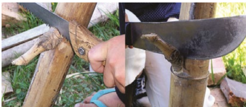
Fotografía 65. Limpieza de ramas laterales
