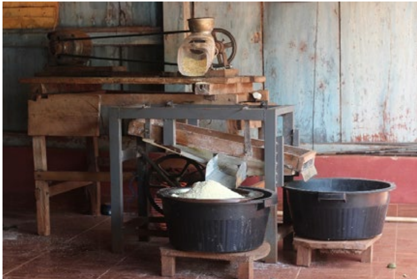
Fotografía 47. Molino artesanal para producción de harina de maíz
