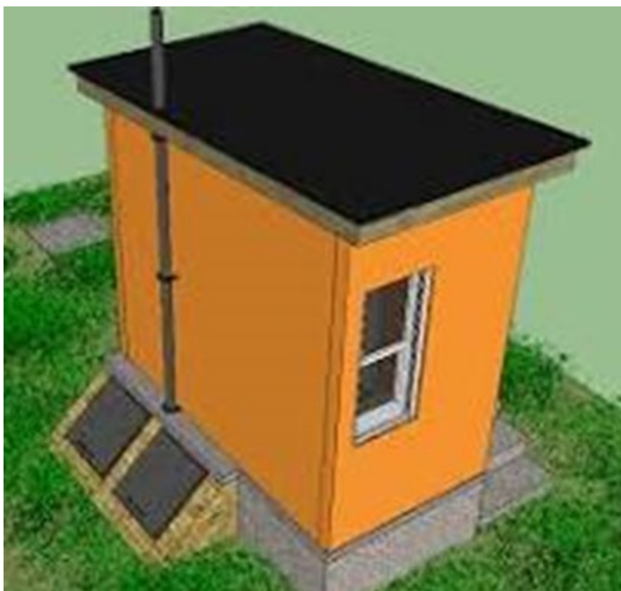
Figura 10. Esquema de baño seco de doble cámara
